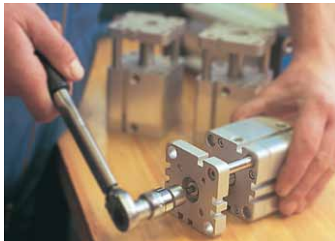
Montering av kompaktcylinder NXD-A med vridstyrning
